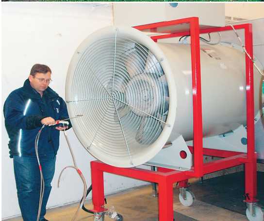
Figur 5: Täthetsprovningar utförs med hjälp av fläktar som placeras i en öppning i fasaden. Med hjälp av fläkten skapas ett undertryck respektive övertryck över byggnadsskalet. Läckagesökning med hjälp av värmekamera kan utföras i samband med undertrycket. Det finns fläktar med mindre kapacitet lämpade för små byggnader samt fläktar med stor kapacitet som är lämpade för stora byggnader och hallar.
