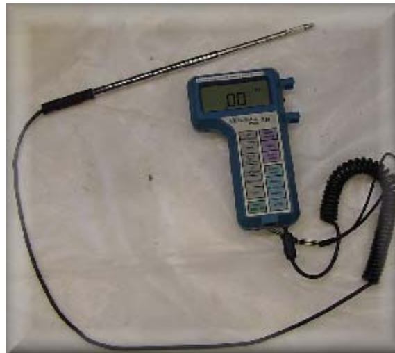
Figur 6.4 Luftflödet i takfotsöppningen uppmättes med en Varmtrådsanemometer
