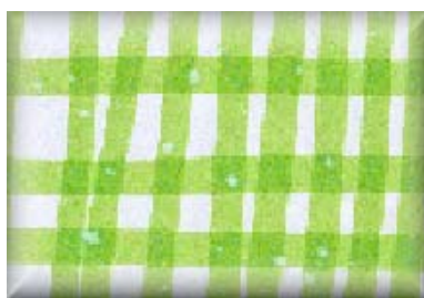
Figur 4.14 Några av de fuktfläckar som kunde urskiljas på provpapperet under taknocken
