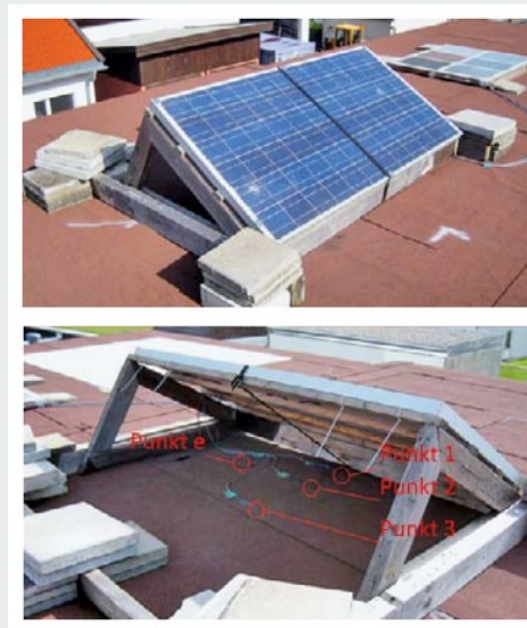
Experimentuppställning med mätpunkter (Bludau et al., 2014)
