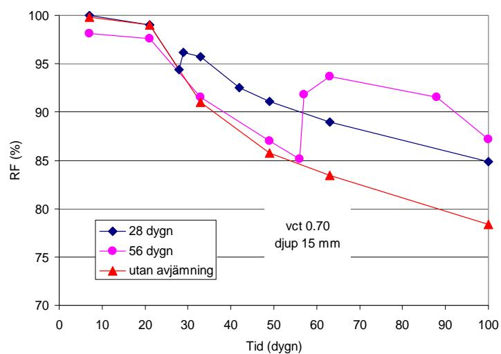
RF på djupet 15 mm under betongytan vid applicering av 10 mm avjämningsmassa vid 28 respektive 56 dygns ålder. Betong med vct 0.70.
