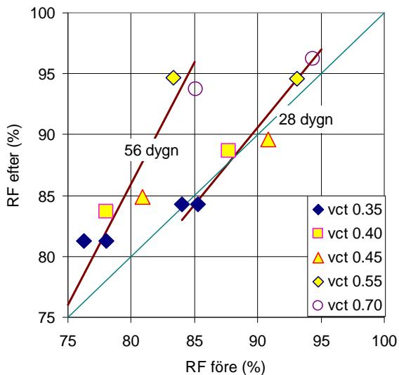
RF före och efter avjämning på djupet 15 mm under betongytan vid applicering av 10 mm avjämningsmassa vid 28 respektive 56 dygns ålder.
