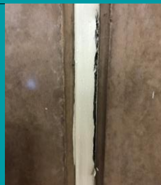
Uppskuren, 20 cm lång och 3 mm springbredd, vertikal fog efter försök 3 och inför utökat försök (objekt 2).
