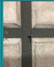
Pågående uppskäring, 10 cm lång och 0-1 mm springbredd, av horisontell fog efter försök 3 inför utökat försök (objekt 2).
