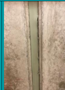
Uppskuren, 20 cm lång och 0-1 mm springbredd, vertikal fog inför försök 3 (objekt 2).
