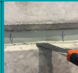
Pågående uppskäring, 10 cm lång och 0-1 mm springbredd, av horisontell fog efter försök 3 inför utökat försök (objekt 2).
