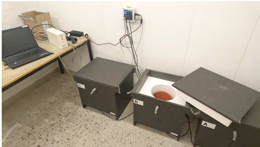
Fig. 6 Semi-adiabatisk kalorimeter. Denna användes för mätning av hydratationsvärme.
