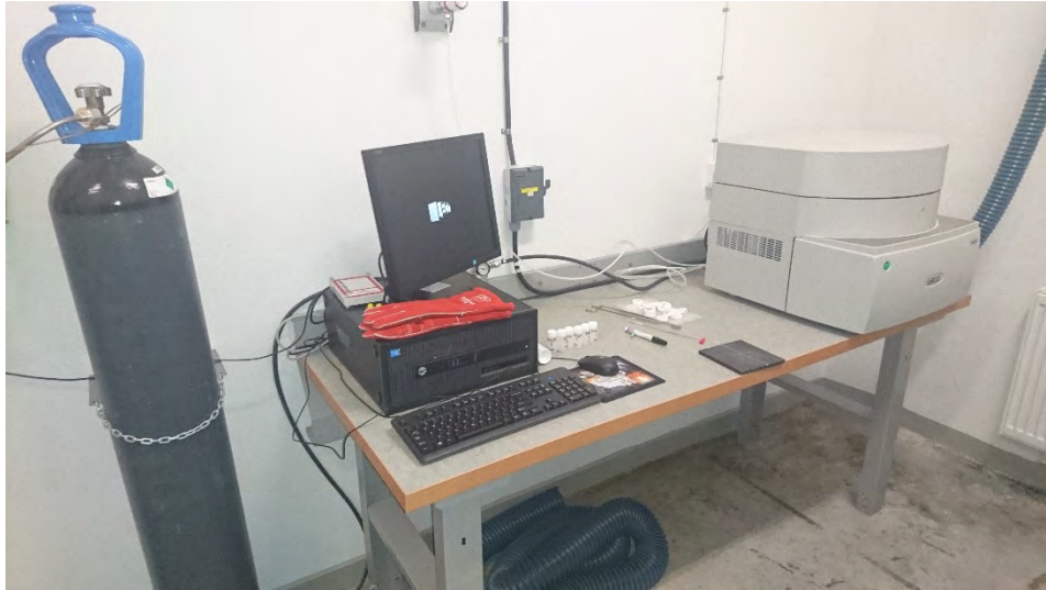
Fig. 2 Utrustning för termogravimetrisk analys. Med hjälp av denna mättes kemisk bindning av vatten.
