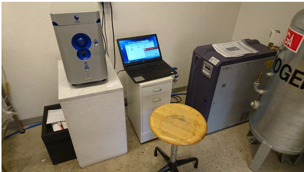
Fig. 3 Sorptionsvåg (vänster) samt utrustning för generering av nitrogen (höger) som användes i sorptionsvågen. Med hjälp av dessa mättes sorptions- samt transportegenskaper.
