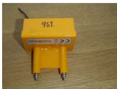
En metod för uppföljning av utförda åtgärder är inmonterade givare
