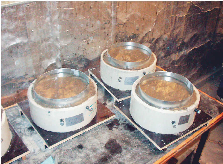
Figur 3: Provkroppar med vattenfyllda plåtrör.
