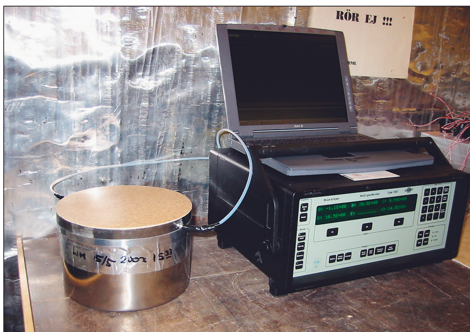
Figur 2: Golvsystem monterat på skål med mättad saltlösning, dock utan lock, kopplat till direktvisande mätinstrument för att detektera kemisk nedbrytning av materialen.
