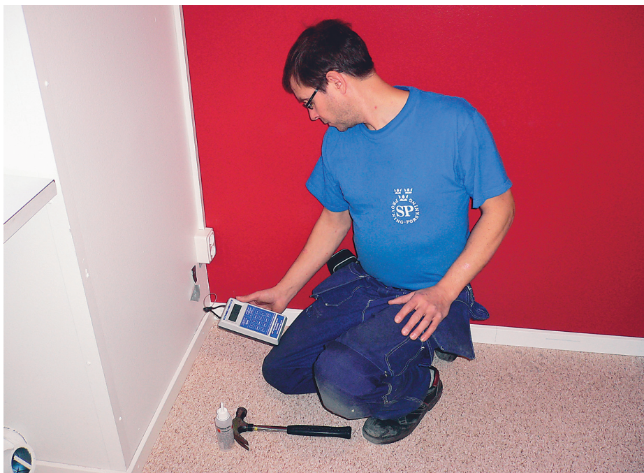
Kontroll av undertryck i mekaniskt ventilerat golv.
