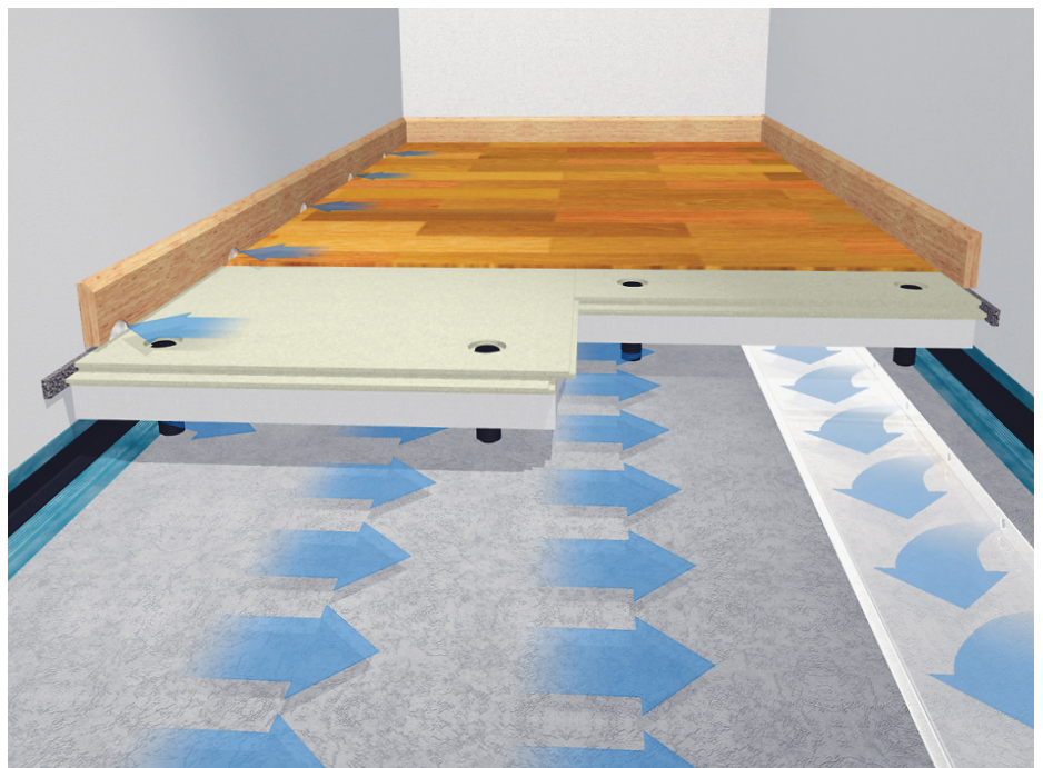
Mekaniskt ventilerat golv, Giha Golvsystem, där luftspalten byggs upp med hjälp av golvspånskivor som står på distansskruvar. Pilarna visar hur luften strömmar ned i golvet via luftintagen, vidare genom golvet och ut via frånluftskanalen.
