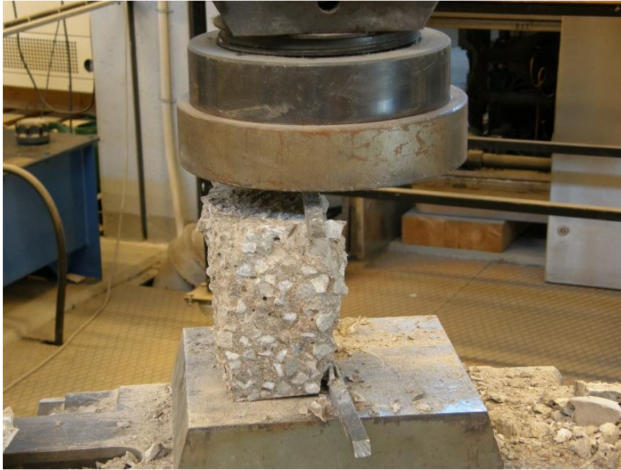
Figur 2.6 Kvarvarande prov i form av rätblock efter att yttre delar nära mantelyta spräckts bort med hydraulisk press. Provets höjd var oförändrad, 150 mm, och sidan cirka 50 mm efter spräckning.
