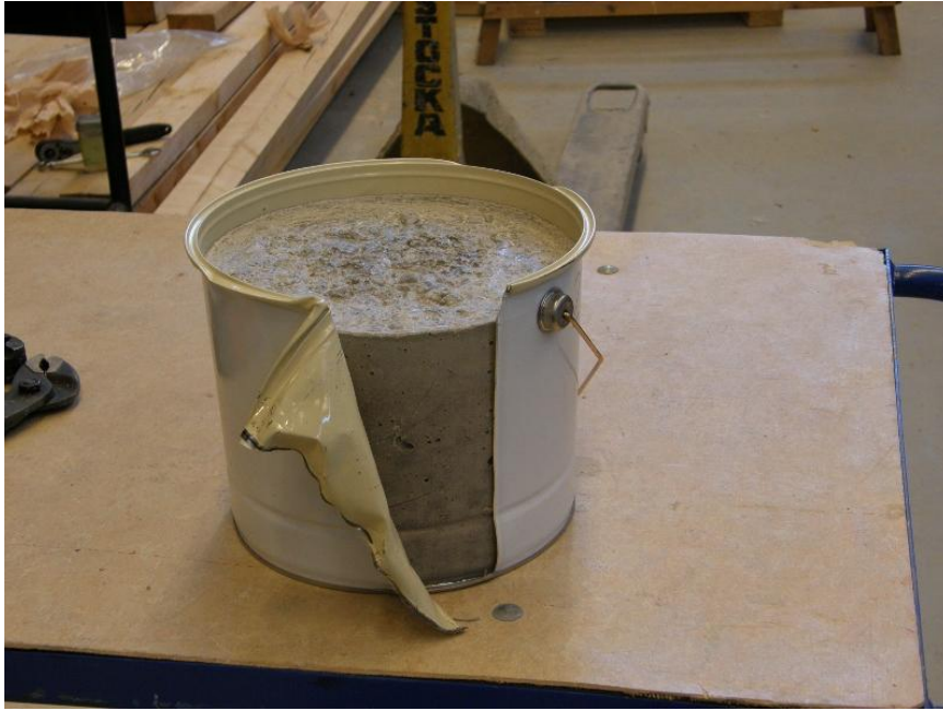
Figur 2.4 Demontering av prov från form sker genom att mantel delas vid befintlig skarv med hjälp av tång. När mantelplåten öppnats tillräckligt, som på bild, vänds provet upp och ner varpå prov lossnar från form.
