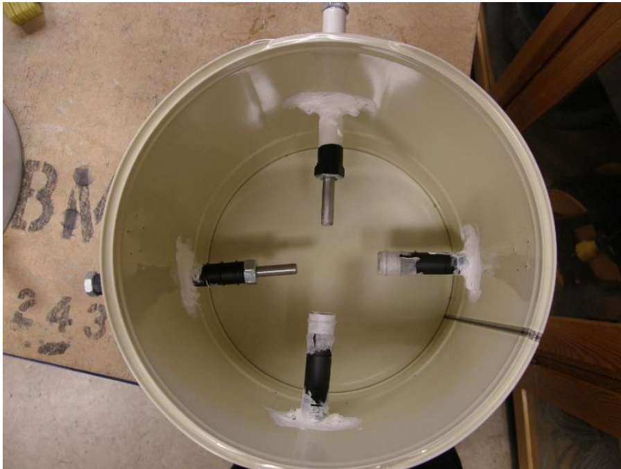
Figur 3.2 Form för prov där mätning av relativ fuktighet genomförs med flera metoder, prov 4-6 enligt tabell 7.13. HumiGuard-givare monterades i vitt plaströr medan Vaisala monterades i svarta. Två av de svarta rören var försedda med kirurgisk tejp medan resterande två med skruv, se figur 3.4, vilken demonterades under härdningen.
