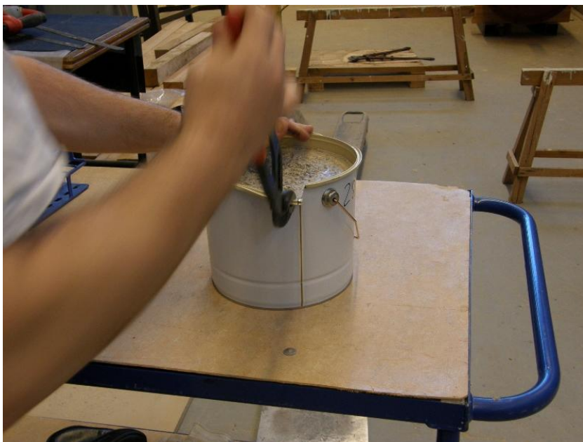
Figur 2.3 Demontering av prov från form sker genom att mantel delas vid befintlig skarv med hjälp av tång.
