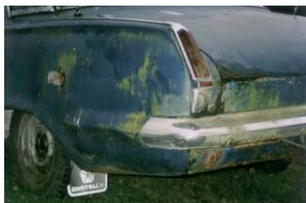
Figur 20. Beväxning på bilplåt.
