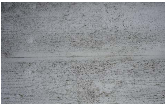
Figur 32. Grovsågad, målad träyta med mögelbeväxning. Figur 33. Finsågad, målad träyta utan beväxning.
