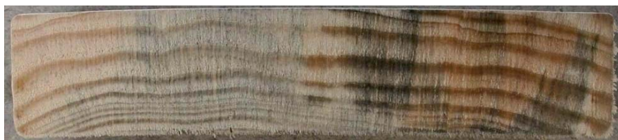
Figur 12. Blånadssvampar (mörka streck) som växer igenom en 20 mm träpanel.
