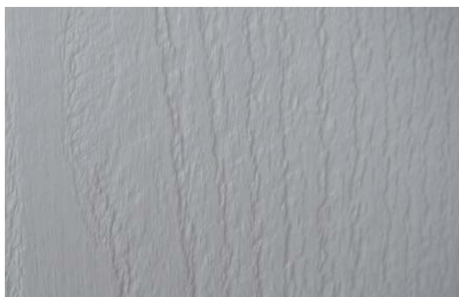
Figur 32. Grovsågad, målad träyta med mögelbeväxning. Figur 33. Finsågad, målad träyta utan beväxning.
