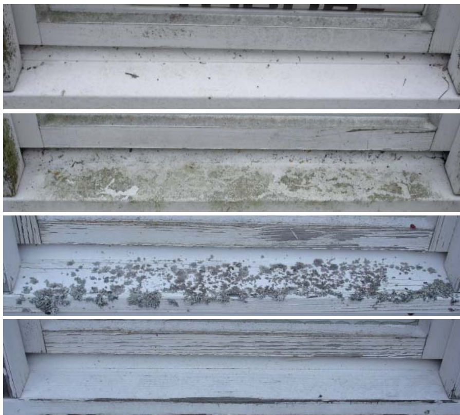
Figur 24. Överst: Nordsida, lösningsmedelsburen färg. Ringa påväxt Näst överst: Nordsida, vattenburen färg. Alger Näst nederst: Sydsida, lösningsmedelsburen färg. Lavar Nederst: Sydsida, vattenburen färg. Ringa påväxt
