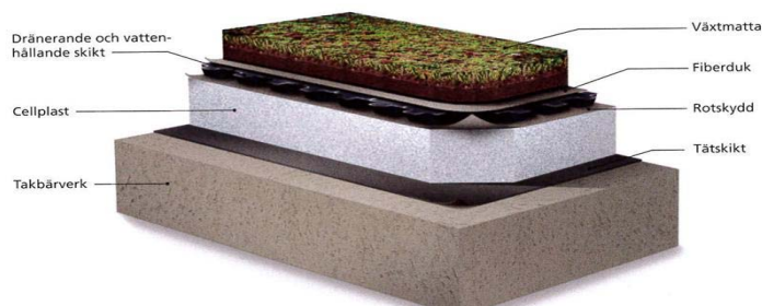
Exempel på system för extensiva tak.
