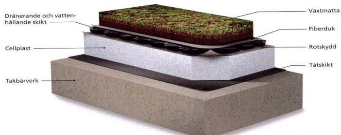
Exempel på system för extensiva tak.
