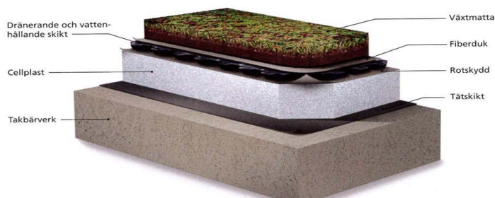
Exempel på system för extensiva tak.
