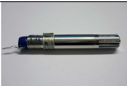
HMP110-givare med sensor, gallerskydd samt pappersfilter och förseglat kabeluttag i bakstycket.
