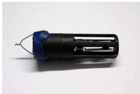
Kapad och förseglad 635-givare med sensor och öppet galler skydd
