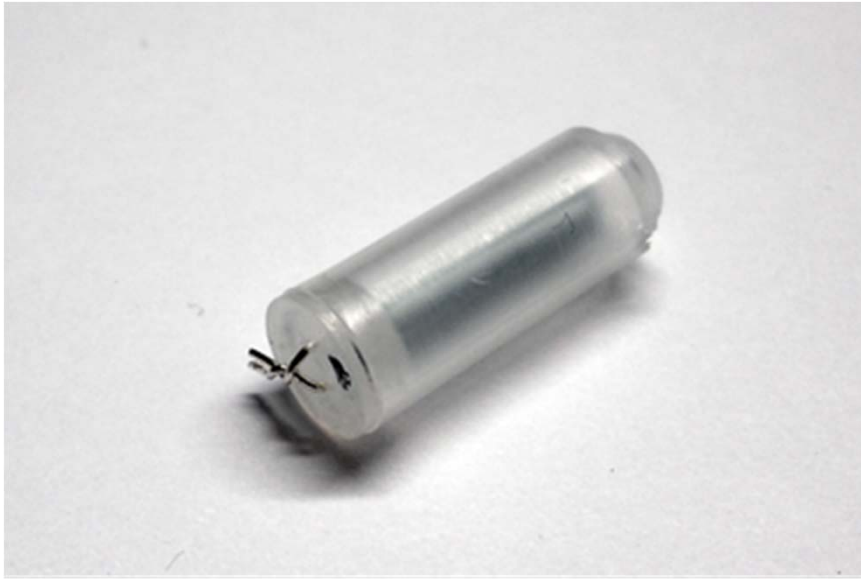
HumiGuard-givare med sensor och plasthölje.
