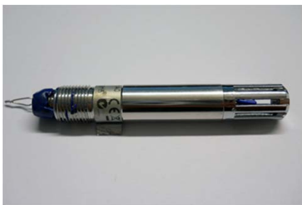
HMP110-givare försedd med gallerskydd utan filter och förseglat kabeluttag i bakstycket.
