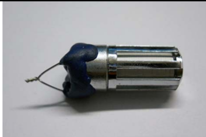
Kapad och förseglad HMP44-givare med sensor, gallerskydd och pappersfilter.
