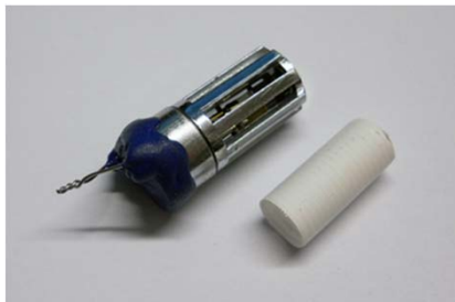
Kapad och förseglad HMP44-givare med sensor, gallerskydd och demonterat pappersfilter.
